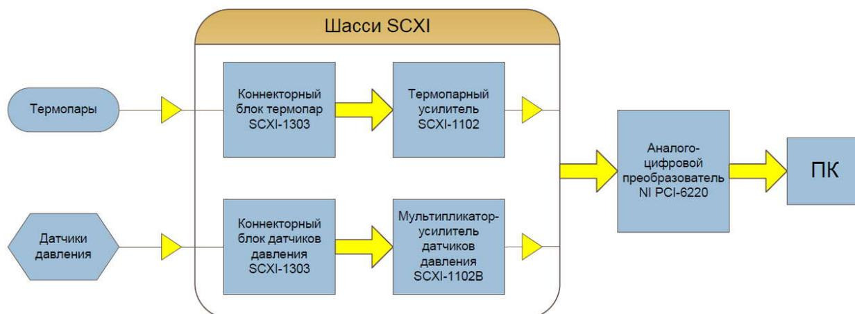
Рис. 14. Блок-схема измерительно-регистрающей системы
