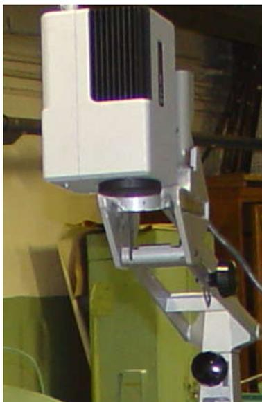
**Рис. 11.** Тепловизионная камера ThermoCAM SC3000
